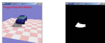
カラーバッファ (R, G, B, A) ステンシルバッファ
